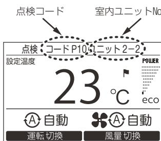
エアコンに不具合が発生した場合、リモコン表示部に点検コードと室内ユニットNoが点滅表示されます。
