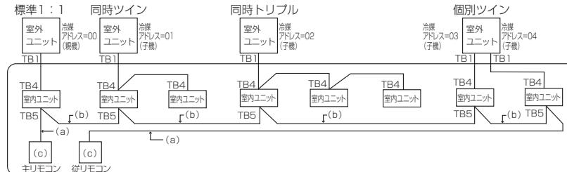
※冷媒アドレスの設定は室外ユニットのディップスイッチにて行ないます。（詳細は室外ユニットの据付工事説明書を参照してください）
