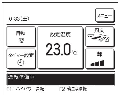
ブレーカ電源投入後の初回の運転、もしくは停電からの停電後の初回の運転において、リモコンに「運転準備中」表示が、最大で30分間表示される場合があります。圧縮機保護のための冷凍機油保護制御が作動しており、故障ではありません。「運転準備中」表示が消えるまで、しばらくお待ちください。
