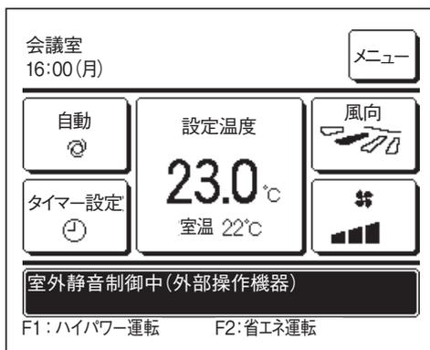
「室外静音制御中（外部操作機器）」表示中は、リモコンから操作する室外静音制御（☞64ページ）と同じ運転を行います。
