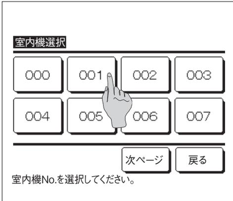
2 リモコンに接続されている室内ユニットが複数台の場合、室内ユニットの一覧が表示されますので設定する室内ユニットをタッチしてください。
