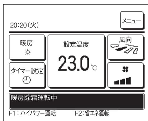
室外ユニットに霜が付くと暖房能力が低下するため、除霜運転に自動で切り換わり、室内ユニットからの温風の吹出しが止まります。メッセージ表示部には「暖房徐霜運転中」を表示します。除霜運転完了後、「暖房除霜運転中」が消え、通常の暖房運転に切り換わります。
