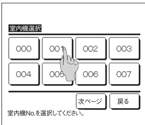
2 リモコンに接続されている室内ユニットが複数台の場合、室内ユニットの一覧が表示されますので、表示させる室内ユニットをタッチしてください。
