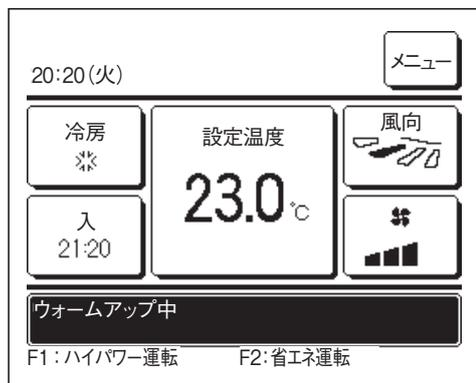
時間入タイマー（☞40ページ）、時刻入タイマー（☞42ページ）にてウォームアップONを選択した場合、運転開始設定時間にお部屋が設定温度近くなるように、前回のウォームアップ運転を基に、開始時刻を予測して、5～60分前から運転を開始します。
