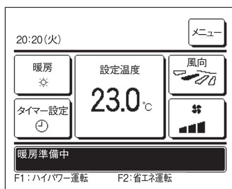
暖房運転開始時、室内ユニットから冷風の吹出しを防ぐため、送風を停止し、メッセージ表示部に「暖房準備中」を表示します。温風を吹出す準備が完了後、「暖房準備中」の表示が消え、暖房運転を開始します。
