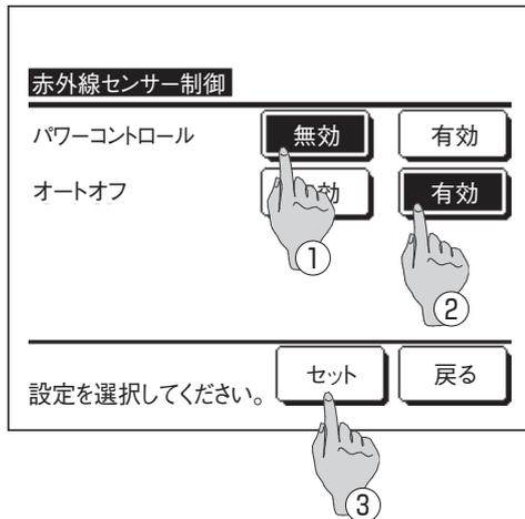
1 TOP画面 **メニュー** ⇒ **省エネ設定** ⇒ **赤外線センサー制御** を選択してください。赤外線センサー制御画面と現在の設定内容が表示されます。
