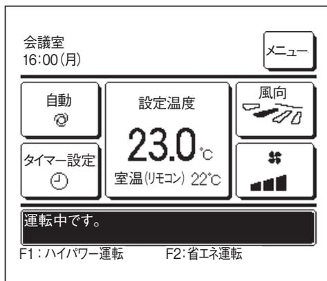
リモコンセンサー設定が有効のときは「室温 (リモコン) 〇℃」を表示します。(設定方法は据付工事説明書を参照ください。)
