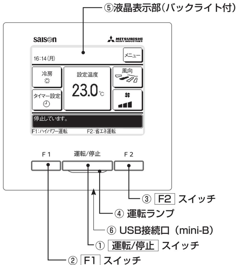
①運転/停止、②F1、③F2 スイッチ以外の操作は、液晶表示部を指で押すタッチパネル方式となっています。
