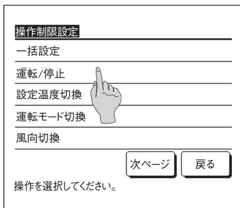
2 操作制限設定のメニュー画面から以下の操作項目を選択し、操作の許可/禁止設定ができます。
