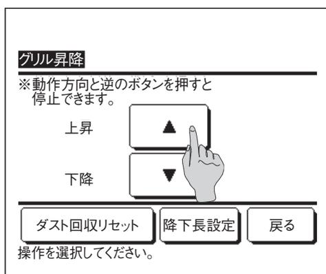
3 ▼ ボタンをタッチすると、吸込グリルが設定した降下長まで降下して、自動的に停止します。降下を途中で止めるときは、▲ ボタンをタッチしてください。
