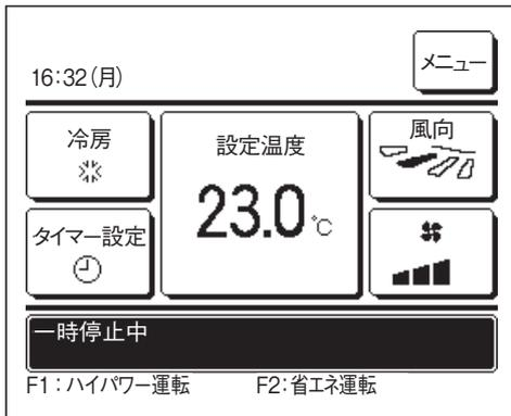
室内ユニットの外部入力により操作されている場合に表示します。
