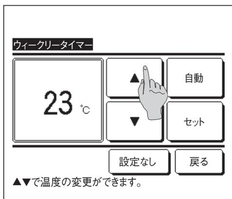
9 ▲ ▼ ボタンで、ご希望の設定温度（1℃単位）に合わせてください。あるいは**自動** ボタンをタッチし、設定温度自動を選択してください。設定温度を合わせた後、**セット** ボタンを押してください。（[7](#)へ）
