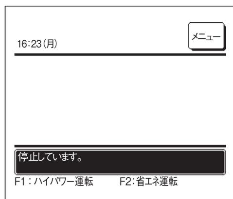
停止すると、画面上の各操作ボタンが消灯し、設定したバックライト点灯時間（☞37ページ）経過後、バックライトが消灯します。
