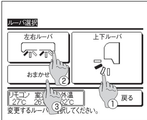
**3** 左右風向切換が可能なFDKが1台でも接続されている場合、ルーバ選択画面を表示しますので、ご希望の風向を選択してください。
