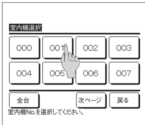
2 リモコンに接続されている室内ユニットが複数台の場合、室内ユニットの一覧が表示されますので、グリル昇降させる室内ユニットをタッチしてください。
