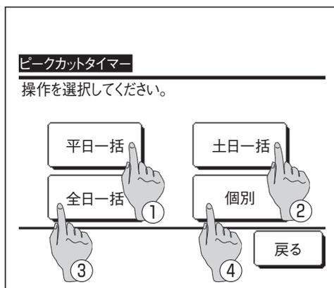
1 TOP画面 **メニュー** ⇒ **省エネ設定** ⇒ **ピークカットタイマー** を選択してください。ピークカットタイマーの設定範囲の選択画面が表示されますので、設定する曜日をタッチしてください。
