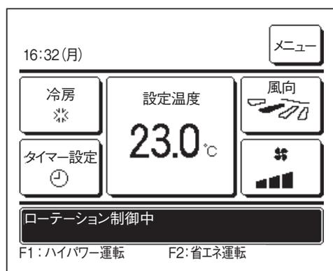
据付設定時に、ローテーション制御、キャパシティバックアップ制御、フォルトバックアップ制御を有効に設定した場合、設定した制御で運転している場合にメッセージ表示部に表示されます。
