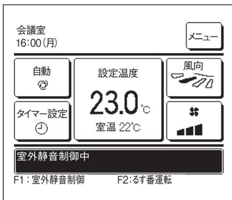
2 室外静音制御中は、メッセージ表示部に「室外静音制御中」を表示します。
